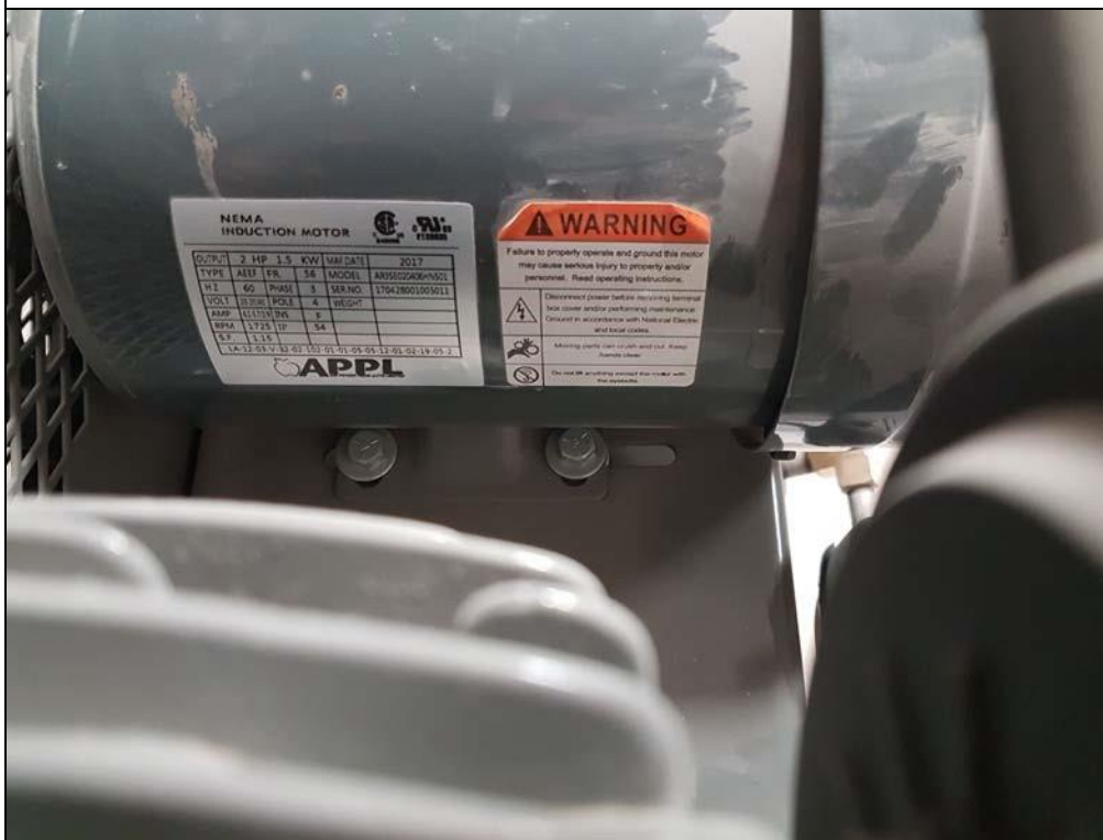
Moteur à induction CA triphasé 4 pôles 2 hp (1,5 kW) Nema AR3SE020406HNS01.
