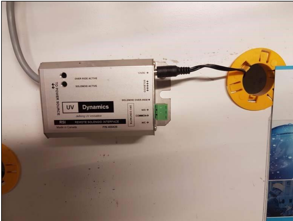
UV Dynamics Interface de solénoïde à distance UV 400429.
